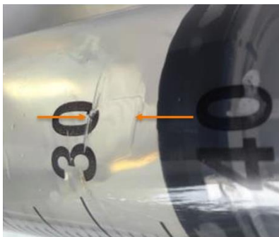
Illustration 1 : Exemple d'un corps de seringue endommagé sur une seringue BD Plastipak™ 50 ml avec embout Luer-Lok™
